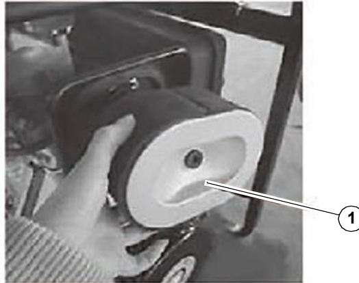
Abb. 8-2: Demontáž vzduchového filtru
