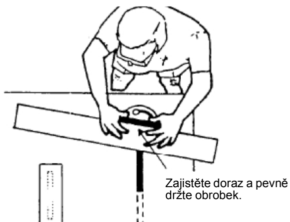
Obr. 34: Diagonální řez s diagonálním dorazem
