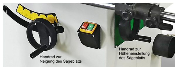
Obr. 37: Nastavení pilového kotouče
