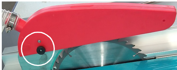
Obr. 24: Montáž ochranného krytu pilového kotouče
