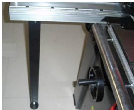
Obr. 22: Montáž opěrné patky
