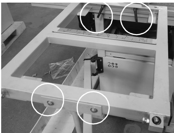
Obr. 20: Montáž suportu k nosníku
