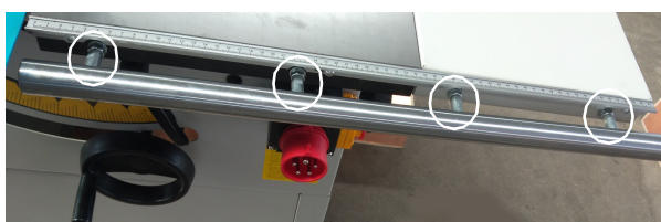
Obr. 14: Montáž vodící lišty dorazu
