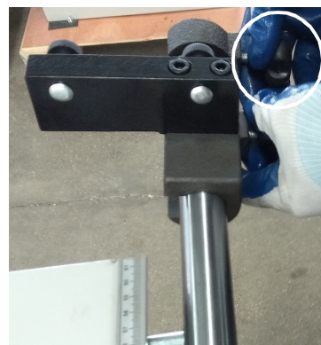
Obr. 15: Nasazení podpěry na vodící lištu
