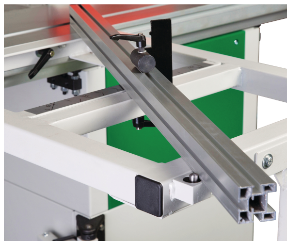
Obr. 21: Montáž výsuvného dorazu
