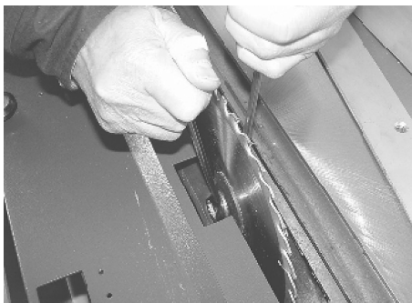
Obr. 42: Demontáž pilového kotouče
