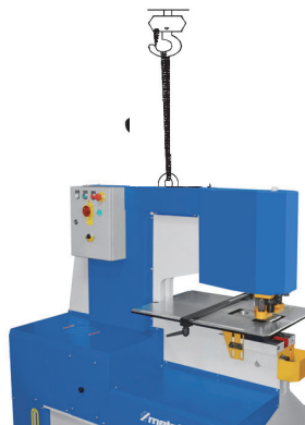
Obr. 4: Převravní oko - přeprava stroje pomocí jeřábu
