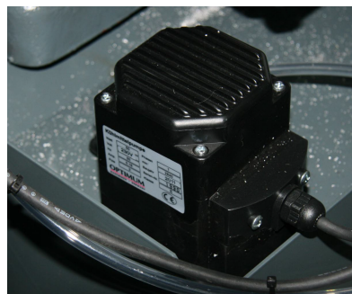
Obr. 3-7: Čerpadlo chladicí kapaliny
