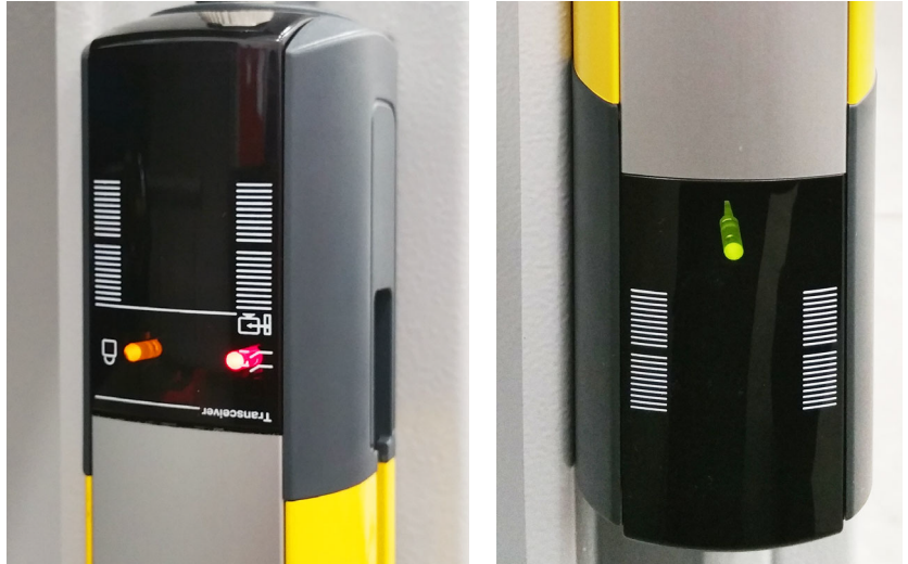
Obr. 13: LED kontrolky "žlutá+červená nahoře" + "zelená dole"
