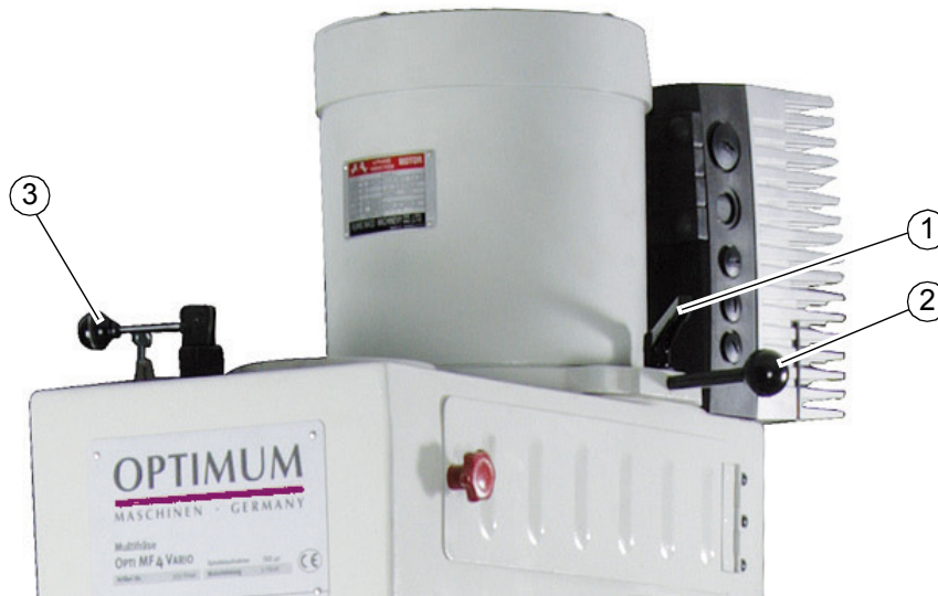
Obr.4-17: Nastavení otáček vřetene pomocí řemenic
